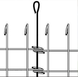
Unser Produkt für schwere Aufgaben. Die besonderen Steckverbindungen der Gittermatten geben der Gabione den **besonderen Halt**. Damit kann kommen, was will. Im Verbund gebaut, halten die fachgerecht gebauten Wände auch den schwersten Belastungen Stand. Seien es **Schwerlastverkehr oder Bahndämme**, unsere Gabionenwände halten und machen auch noch ein gutes Bild.
